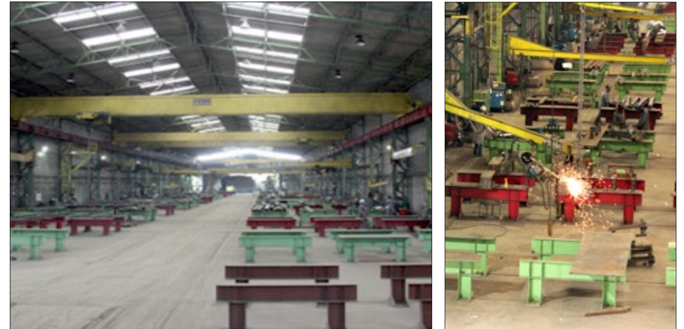
Máquinas de solda MIG MAG montadas sobre braços giratórios. Atividades desenvolvidas por 8 sub setores com capacidade total de 48 montadores e 60 soldadores. 05 Pontes Rolantes, com capacidade de até 100 Toneladas. MIG/MAG welding machines are mounted on rotating arms. Activities divided into 8 sub-sectors with a total capacity of 48 assemblers, 60 welders, 5 overhead cranes with a 100 metric tonnes load limit.
