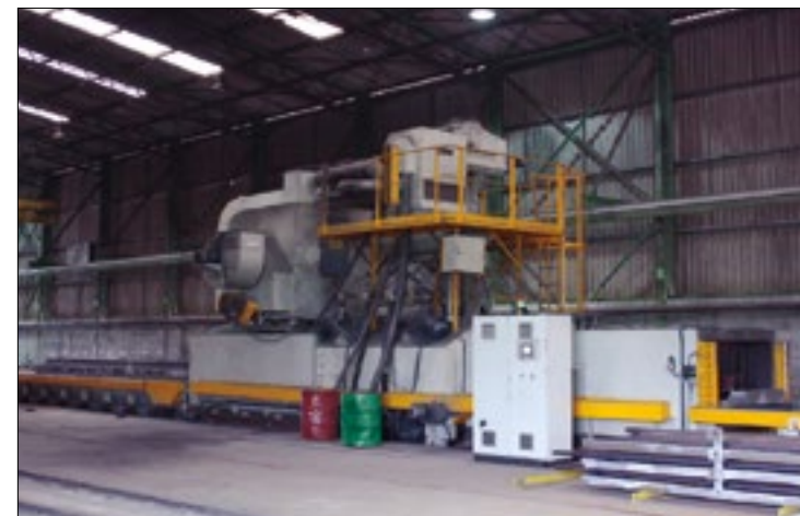
Máquina de Jato de Granalha. Metal blasting machine.
