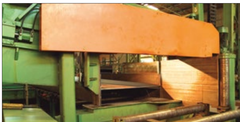
Serra para cortes retos ou em ângulos diversos. Bandsaw for vertical or angular cuts.
