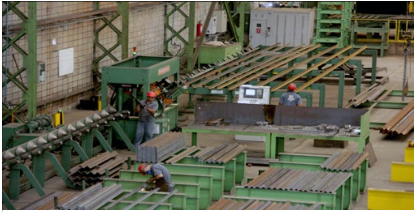
Máquina CNC com Abastecimento e remoção automática de peças. Fully automatic CNC machine for part removal/transfer.
