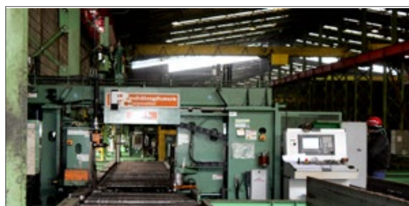
Máquina CNC com 9 brocas para furação e tipagem de perfis pesados. CNC machine with 9 drills and marking system for heavier structures.
