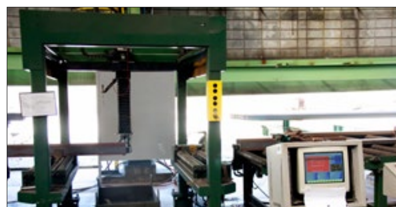
Robô Cartesiano com 5 eixos de movimentação para cortes especiais e chanfros de vigas. Cartesian robot with 5 angled moving shafts for more complex cutting and beam bevelling.
