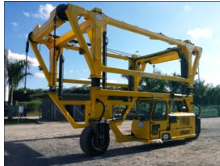
Straddle Carrier capacidade 35.000Kg. Straddle carrier – Capacity of 35,000 kg.
