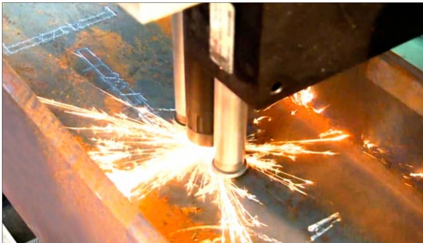
Máquina para Traçagens de Perfis com marcação Plasma. Indica a numeração e o local exato onde as barras principais receberão os elementos menores à serem soldados. Profile scribing machine with plasma marking, which precisely indicates the number and the location the adjoining material will be placed and welded.
