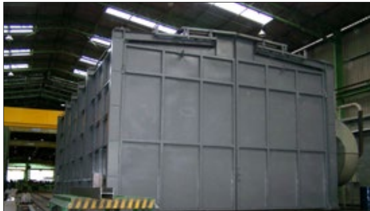
Jateamento de granalha (capacidade 80 ton. por peça). Metal blasting (capacity: 80 metric tonnes per part).
