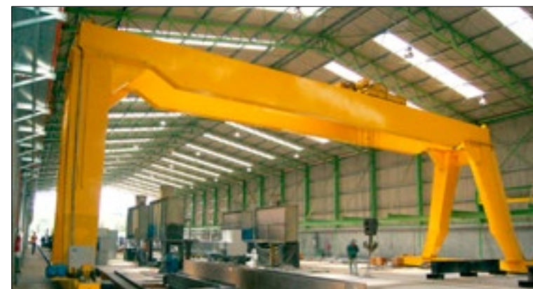
Pórtico 100 Toneladas. 100 metric tonnes overhead crane.
