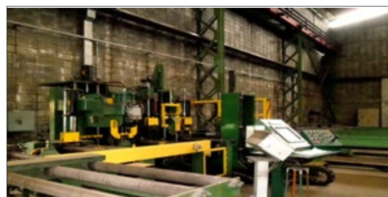
Puncionadeira CNC para Perfis. Efetua furação até 1 polegada de espessura e tipagem. CNC profiles hole punching of up to 1" thick and electronic marking system.
