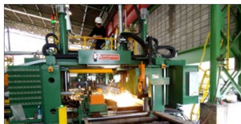
Máquina CNC com 3 maçaricos para cortes especiais e chanfros. CNC machine with 3 torches for complex cuts and bevelling.
